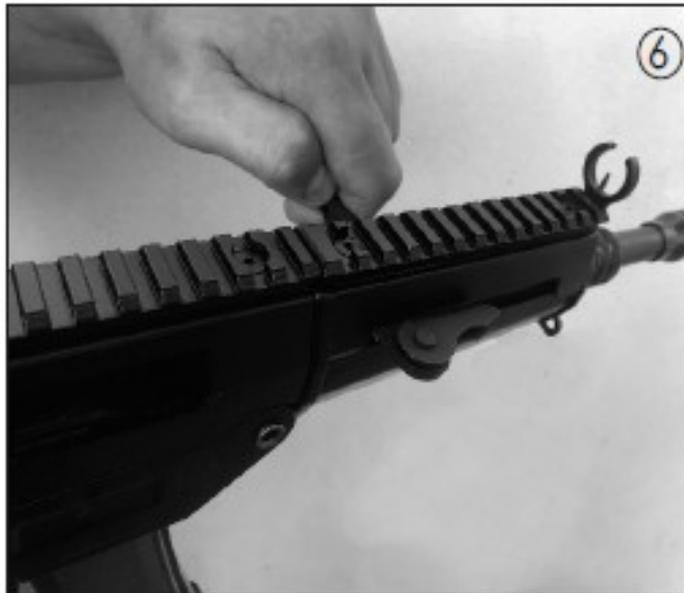
Hierdurch wird das Schlagstück gespannt und eine Patrone zugeführt.
