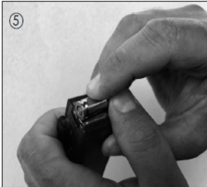
Dies wiederholen Sie, bis das Magazin vollständig geladen ist bzw. die gesetzlich erlaubte Anzahl an Patronen im Magazin ist. Achten Sie darauf, dass der Patronenboden am Magazin anliegt.
