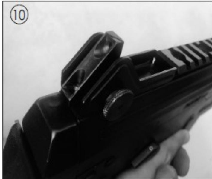
Die Höhe kann durch herein- oder herausdrehen des Korns zusätzlich eingestellt werden.
